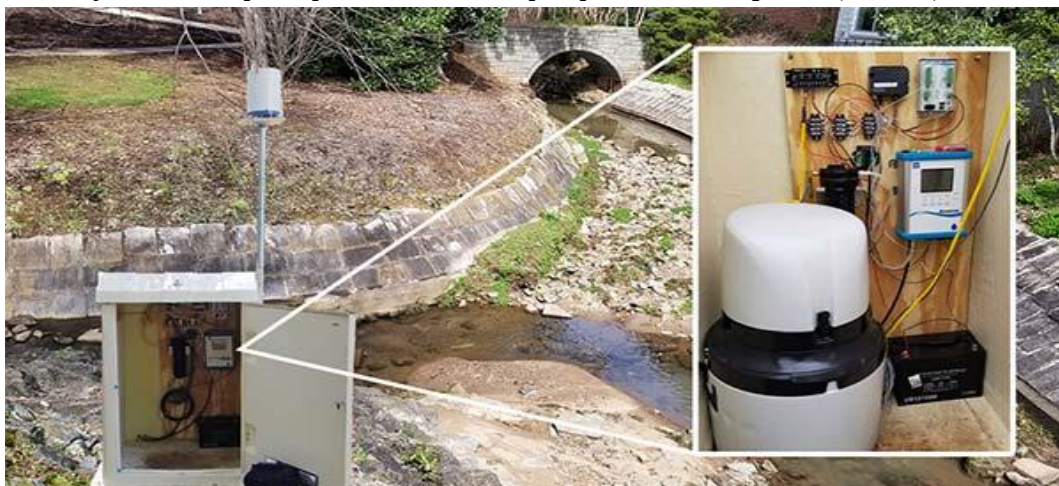
2-rasm: Radar datchigi (mikroto‘lqinli sath o‘lchagich) suv sathini o‘lchash uchun quduq og‘ziga o‘rnatiladi.
